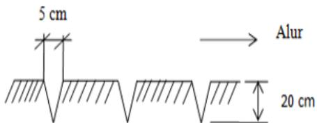
Gambar 8. Bentuk alur tanah
